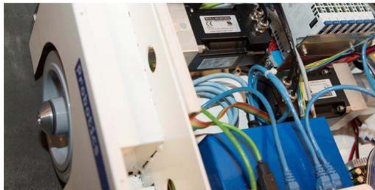
Opteqは、両車輪の駆動用にKOLLMORGEN AKMの48ボルトバージョンシンクロナスサーボモータを採用
