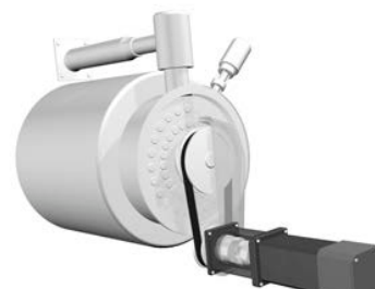
ベルトと遊星ギヤヘッドによる機構
